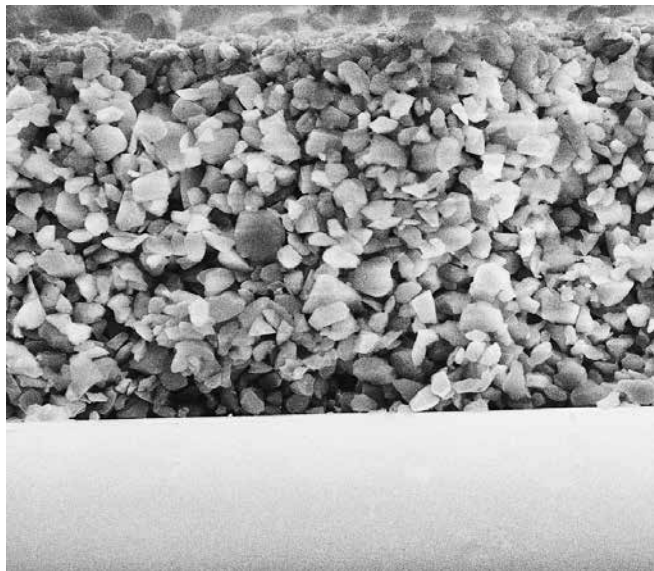
Elektronenmikroskopische Aufnahme des Querschnitts durch eine Glasplatte mit Kieselgelschicht (Vergrößerung x 500)
